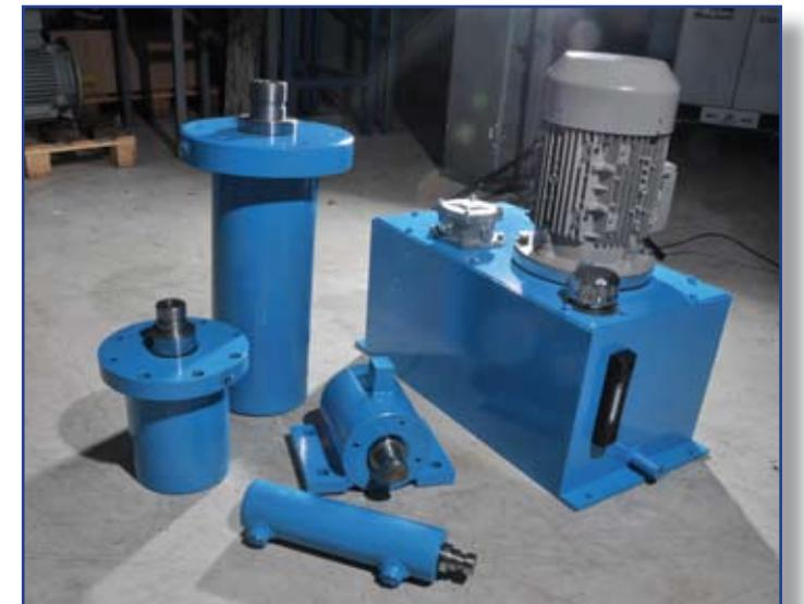
Cilindri mašine za demontažu kardanskih zglobova
