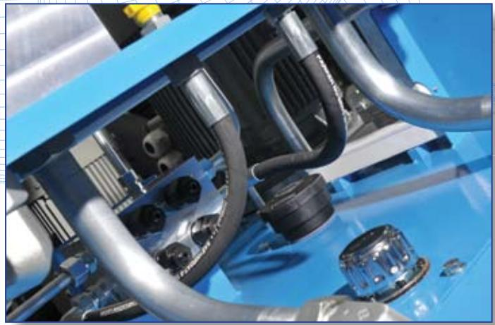
Hidraulični agregat u procesu montaže
