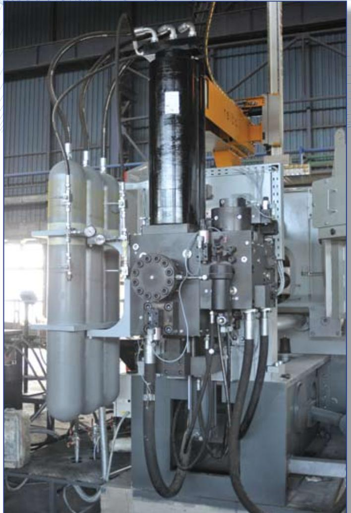
Montirao PNEUMATIK FLEX - presa za livenje aluminijuma pod pritiskom
