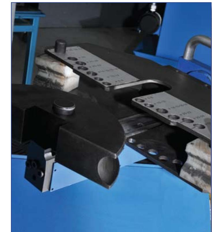
Mašina za savijanje i navlačenje progresivnog prstena tip EO na cev
