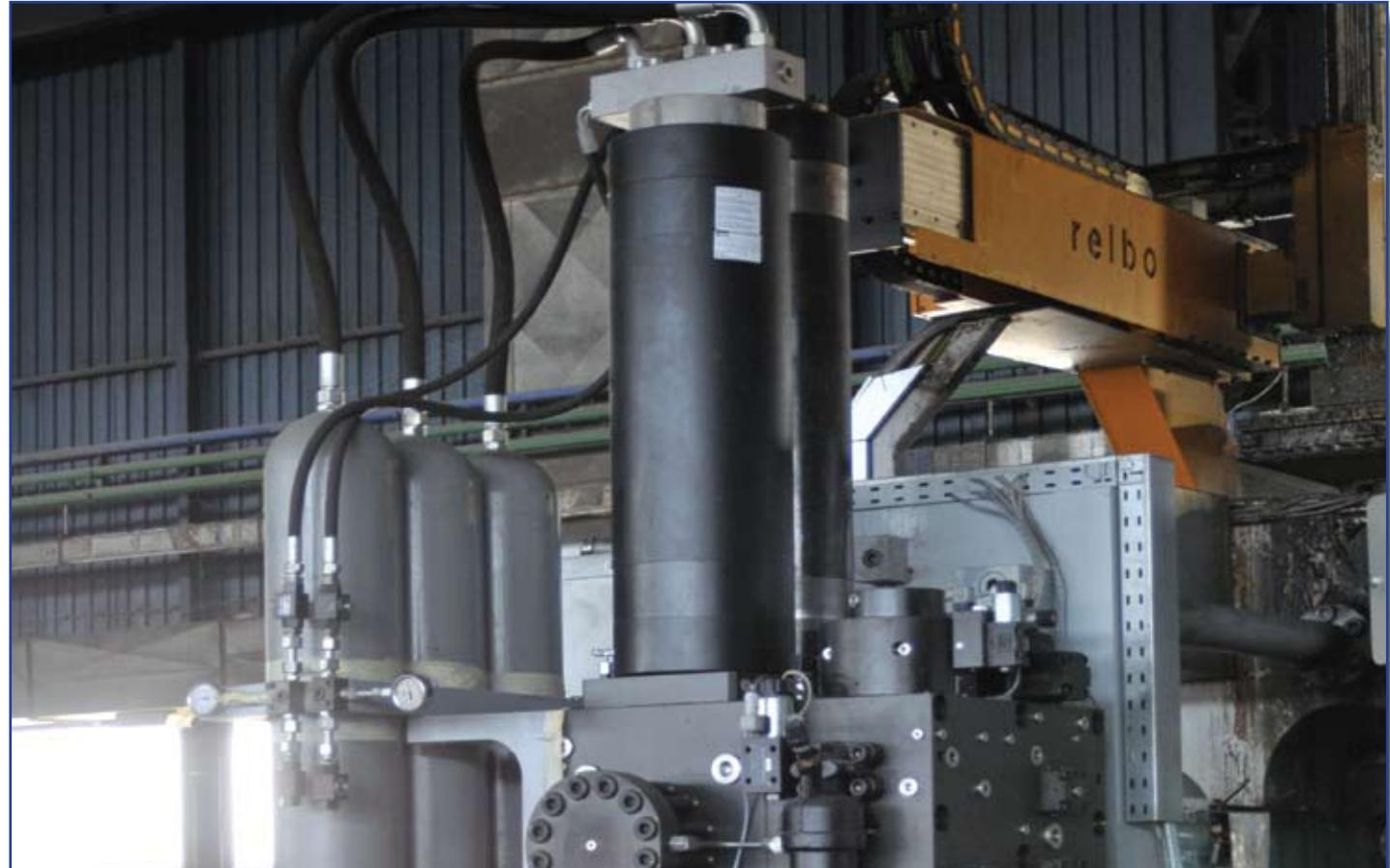
Mi smo za potrebe proizvođača aviona UTVA Pančevo 2010. godine, isprojektovali, izradili i homologovali hidraulični agregat za pogon stajnog trapa aviona. Ovaj agregat se može ugraditi i za pogon drugih mehanizama. Agregat je izrađen od baznih komponenti proizvodnje PARKER. Homologacija (ispitivanje karakteristika) izvršeno je u laboratorijskim institutima Orao Bijeljina.
