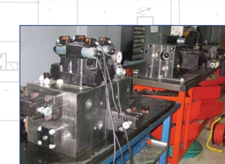
Ispitivanje bloka sa hidrauličnim komponentama
